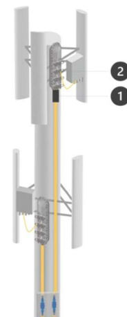
Skrzynka rozdzielcza FTTA oraz Jumper łączący RRU.
